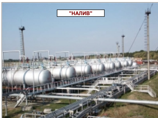
Рис.3 - Технологічний цех стабілізації конденсату
